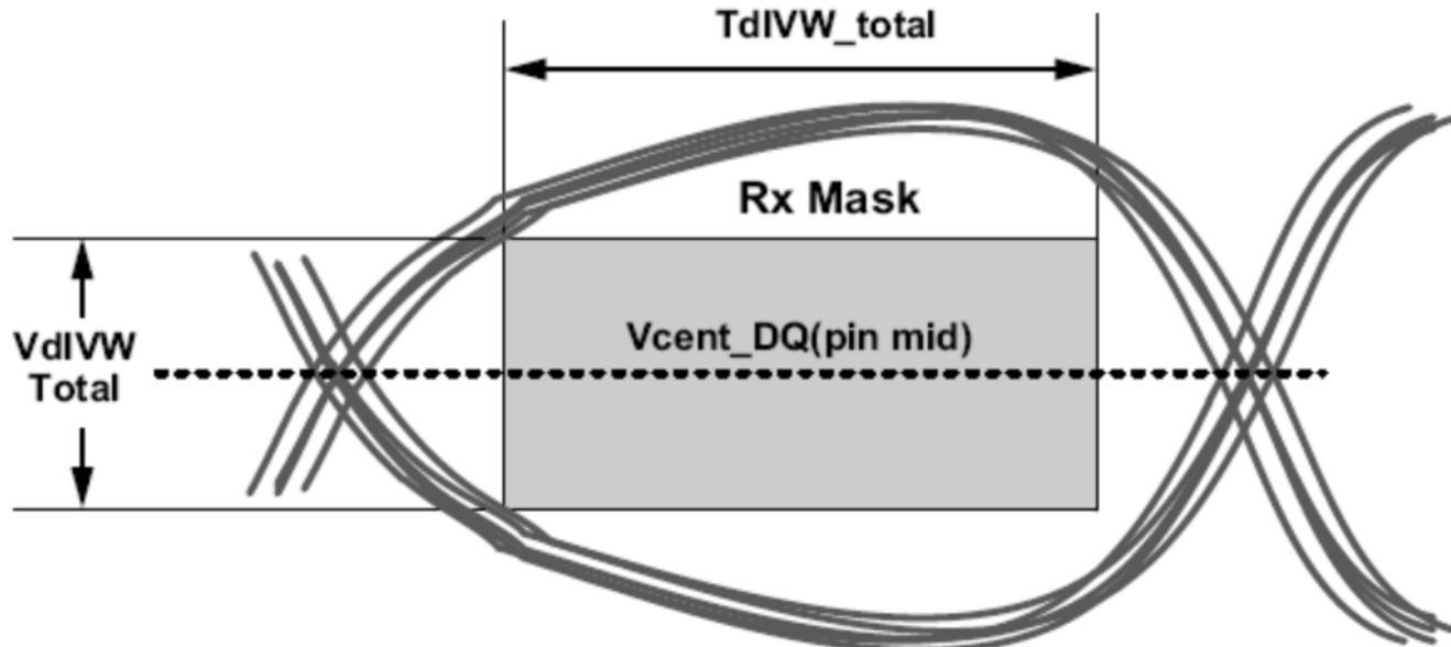
Figure 114 — DQ Receiver(Rx) mask
